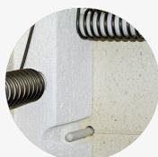
**Mesure de température précise par thermocouple de « Type S »**
